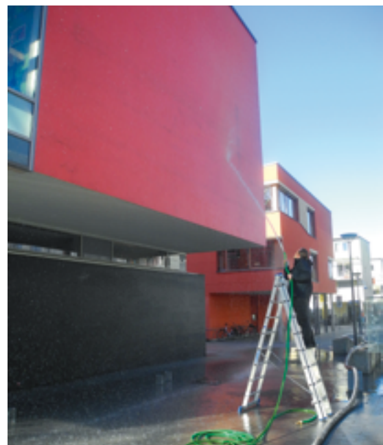
Fassadenberegnungsversuch zur Erfassung des lokalen Biozidaustrags
